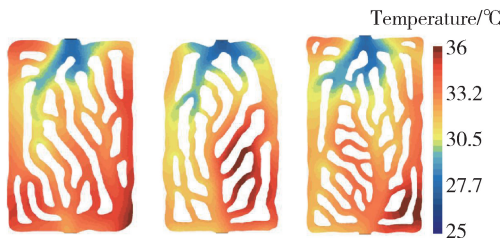
图 7 拓扑优化结构温度云图
