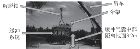
图 6 地面跌落模拟试验起吊装置 [10]
