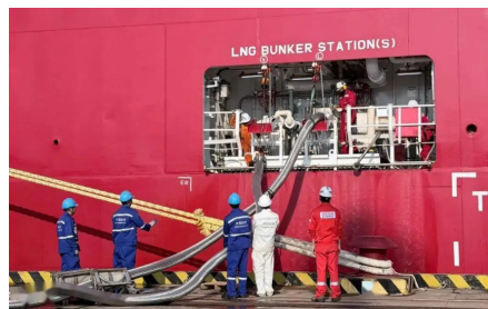
图6 LNG槽车加注现场
