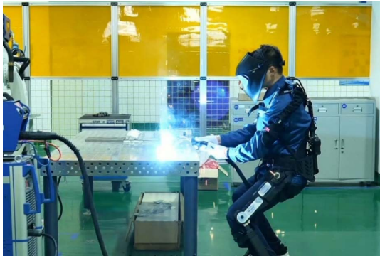
图 12 下肢外骨骼机器人模拟焊接场景应用
