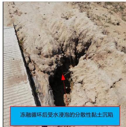
图4 分散性黏土冻融循环和浸泡后大变形破坏状态
