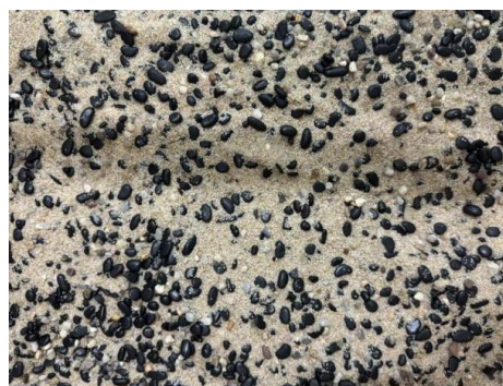
图 7 细砂与卵石混合试验材料
