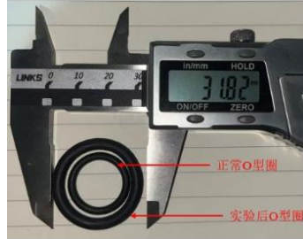
b) 内径 16 mm、线径 2.65 mm O 形圈失效
