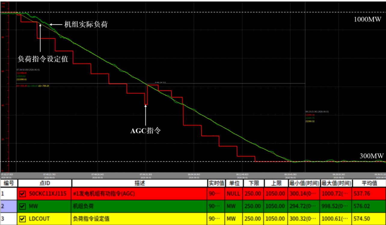
图 8 AGC 斜坡指令微阶梯分解策略作用下的负荷跟调趋势
