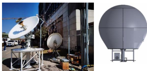
图 7 1.8m 卫星通信船载站实物图及天线罩
