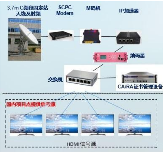
图 4 3.7m 卫星通信固定站分系统组成图
