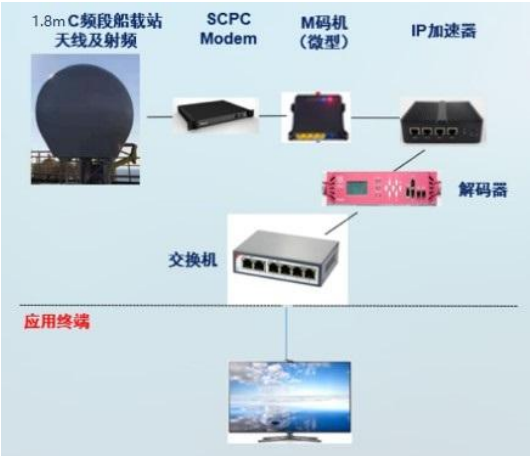
图 5 1.8m 卫星通信船载站分系统组成图
