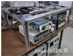
图6 散热系统性能测试实验台
